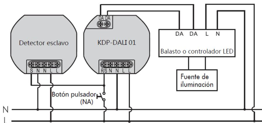
\* **NOTA:** Se pueden conectar al modelo máster, hasta un máximo de 10 detectores esclavo.
