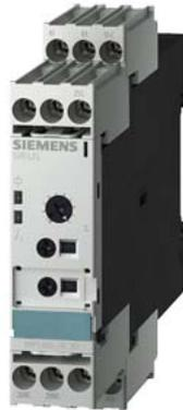
!!! Produit en fin de vie !! Le successeur recommandé est 3RP-1RW30 Relais temporisé, multifonction 2 contacts inverseurs, 8 fonctions 15 plages de temps (0,05 s-100 h) borne à vis Contacts de relais mécaniquement liés et dorés 24-240 V CA / CC pour 50/60 Hz CA
