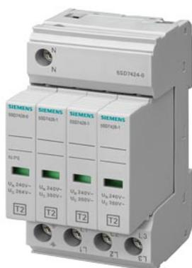
Parafoudre de type2 classe d'exigence C, UC 350V blocs de protection embrochables 4 pôles, circuit 3+1 pour systèmes TN-S et TT forme étroite
