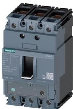
Disjoncteur 3VA1 CEI cadre 160 classe de coupure S Icu=36kA à 415V 3 pôles, protection des installations TM240, ATAM, In=100A protection contre les surcharges Ir=70A...100A protection contre les courts-circuits li=5...10 x In raccordement par bornes
