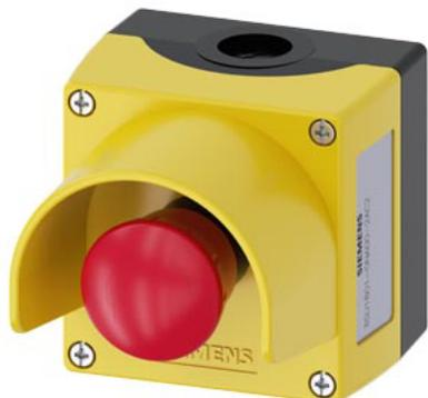
Boîtier pour appareils de commande, 22 mm, rond, Matériau du boîtier : plastique, partie supérieure du boîtier : jaune, 1 emplacement en plastique avec rehausse de protection, A = bouton-poussoir coup de poing d'ARRÊT D'URGENCE rouge 40 mm, décrochage par rotation, 1Ö, borne à vis, Fixation au sol, en haut et en bas 1xM20 chacun,
