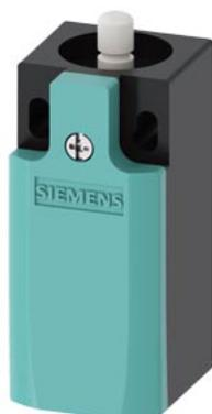
interrupteur de position boîtier plastique selon EN 50047, 31 mm raccordement d'appareil 1 x (M20 x 1,5) contacts à action brusque 1 NO / 1 NF intégrés (non remplaçables) poussoir à calotte sphérique forme B
