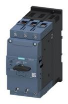
Disjoncteur de taille S3 pour la protection des moteurs, CLASS 10 Déclencheur de surcharge à temps dépendant 80...100 A Déclencheur de court-circuit 1300 A Borne à vis pouvoir de coupure standard
