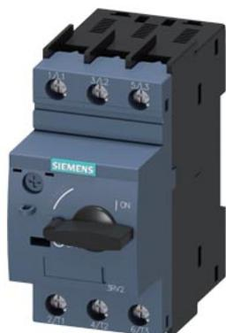
Disjoncteur de taille S0 pour la protection des moteurs, CLASS 10 Déclencheur de surcharge à temps dépendant 30...36 A Déclencheur de court-circuit 432 A Borne à vis pouvoir de coupure standard
