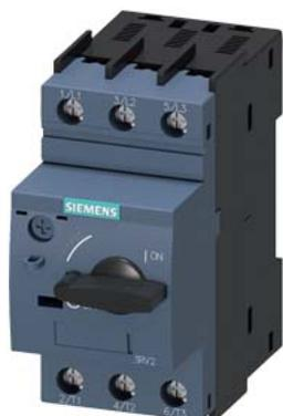
Disjoncteur de taille S00 pour la protection des moteurs, CLASS 10 Déclencheur de surcharge à temps dépendant 0,35...0,5 A Déclencheur de court-circuit 6,5 A Borne à vis pouvoir de coupure standard
