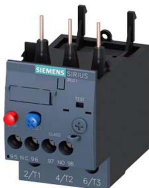
Relais de surcharge 34...40 A thermique pour protection des moteurs taille S0, Class 10 Montage sur contacteur circuit principal : à visser circuit auxiliaire : à visser Réarmement automatique/manuel
