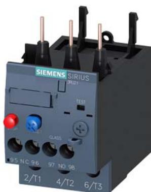
Relais de surcharge 27...32 A thermique pour protection des moteurs taille S0, Class 10 Montage sur contacteur circuit principal : à visser circuit auxiliaire : à visser Réarmement automatique/manuel
