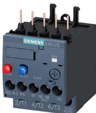
Relais de surcharge 7,0...10 A thermique pour protection des moteurs taille S00, Class 10 Montage sur contacteur circuit principal : à visser circuit auxiliaire : à visser Réarmement automatique/manuel
