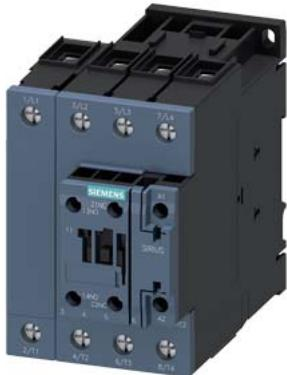
contacteur AC-1, 110 A, 400 V / 40 °C, 4 pôles, 230 V AC, 50 Hz, contacts auxiliaires : 1 NO + 1 NF, borne à vis, taille : S2
