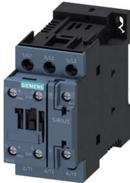
contacteur de puissance, AC-3e/AC-3, 25 A, 11 kW / 400 V, 3 pôles, 24 V DC, contacts auxiliaires : 1 NO + 1 NF, borne à vis, taille : S0
