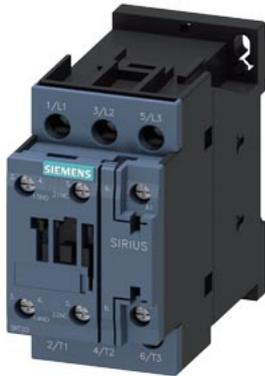
contacteur de puissance, AC-3e/AC-3, 25 A, 11 kW / 400 V, 3 pôles, 230 V AC, 50 Hz, contacts auxiliaires : 1 NO + 1 NF, borne à vis, taille : S0
