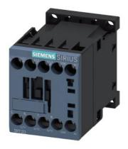
contacteur de puissance, AC-3e/AC-3, 16 A, 7,5 kW / 400 V, 3 pôles, 230 V AC, 50/60 Hz, contacts auxiliaires : 1 NF, borne à vis, taille : S00
