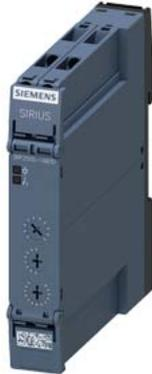
Relais temporisé, multifonction 1 contact inverseur, 13 fonctions 7 plages de temps (0,05 s...100 h) 24 V CA/CC pour 50/60 Hz CA avec LED, Borne à vis
