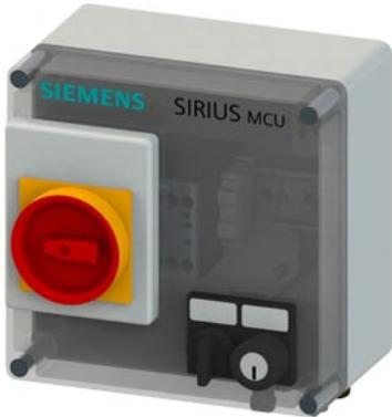
Départ-moteur SIRIUS MCU indice de protection du boîtier IP55 matière plastique Communication sans commutation électromécanique protection contre les courts-circuits avec disjoncteur démarreur direct frein sans Classe de puissance 10 A Disjoncteur moteur avec bilame thermique commande manuelle à accrochage raccordement électrique avec presse-étoupe Version grossiste
