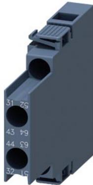
bloc de contacts auxiliaires, latéral, 1 NO + 1 NF, à gauche : 51/52, 63/64, à droite : 31/32, 43/44, circuit : 1 NF, 1 NO, borne à vis, pour contacteurs 3RT2 et contacteurs auxiliaires 3RH2
