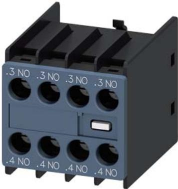
bloc de contacts auxiliaires, en face avant, 4 NO, .3/.4, .3/.4, .3/.4, .3/.4, circuit : 1 NO, 1 NO, 1 NO, 1 NO, borne à vis, pour contacteurs 3RT2 et contacteurs auxiliaires 3RH2
