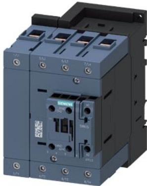
contacteur AC-1, 140 A, 400 V / 40 °C, 4 pôles, 230 V AC, 50 Hz, contacts auxiliaires : 1 NO + 1 NF, borne à vis, taille : S3
