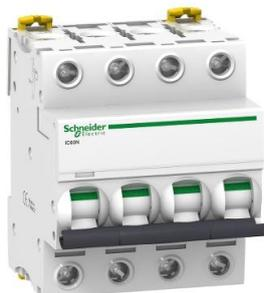
Disjoncteur, Acti9 iC60N, 4P, 16 A, courbe C, 6000 A (IEC 60898-1), 10 kA (IEC 60947-2)
