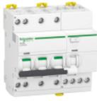
Acti9 iDD40N - disjoncteur différentiel - 3P+N C 32A 6000A/10kA 30mA type AC
